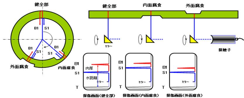
ボイラ、熱交換器等のチューブ内外面の減肉状況を、精度良く検出できる内挿回転式超音波検査システムです。軸方向に送信される超音波を回転式ミラーによって周方向に反射させ、送受信することでチューブ水距離S1波と肉厚B1波を各々の探傷器で同時測定を実施。採取データによりチューブ内・外面の腐食状況を検出します。
