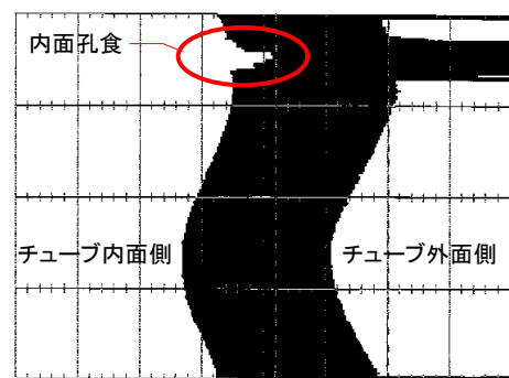
探傷画像(内面孔食の例)
