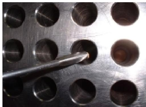
窒素より分子の小さなヘリウムを使うことにより、従来のリークテストでは検出不可能だった微小な漏れを分子レベルで検出する装置です。
