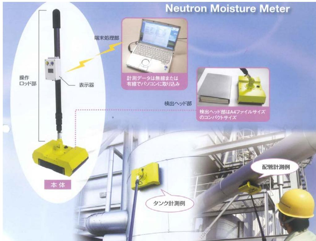
中性子源から放出される高速中性子が、水分によって減速し熱中性子に変わることを利用し、熱中性子量を測定することで水分量を計測する方式の水分計です。保温配管などの外面腐食の要因となる保温材中の水分を、保温材を解体することなく検出できます。
