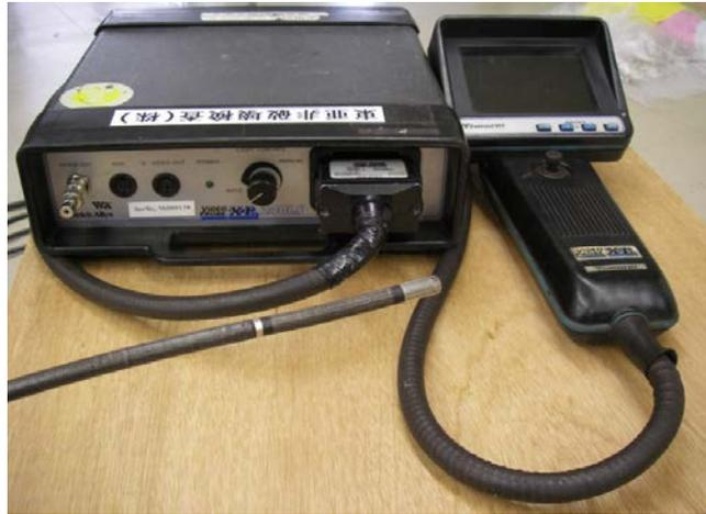
従来、熱交換器チューブや装置、部品の狭隘部の目視検査にファイバースコープを使用していましたが、CCDカメラを搭載した超小型工業用内視鏡(ビデオスコープ)の使用により、像質が飛躍的に向上し、小さなきずや腐食などの欠陥を鮮明に観察できるようになりました。また、観察結果はビデオによる保存が可能で、何度でも繰り返し観察でき、高度な診断が行えます。
