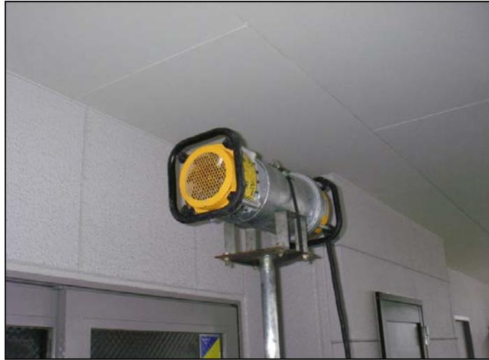
コンクリート構造物の透過写真を撮影し、その内部状態を調査します。
