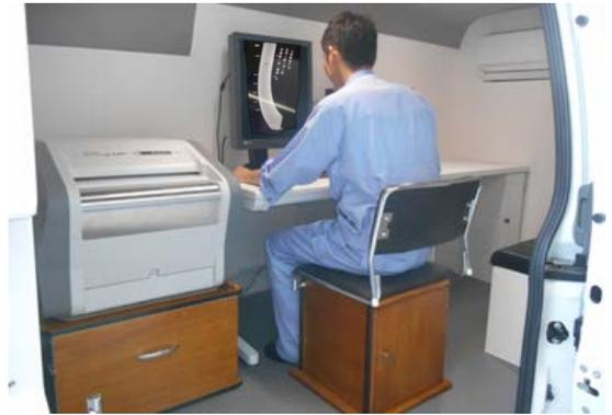
FCRとは、従来の工業用X線フィルムの代わりに、イメージングプレート(IP)を媒体として使用し、これに蓄積された透過線量をデジタル化し画像処理を可能とした装置です。
