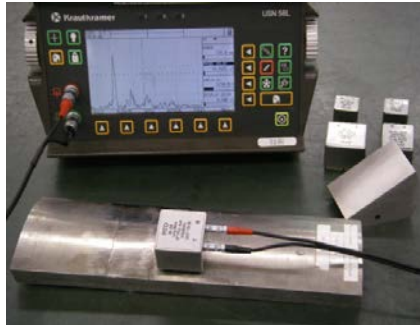
対比試験片によるキャリブレーション
