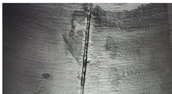
エポタール塗装配管内面画像
