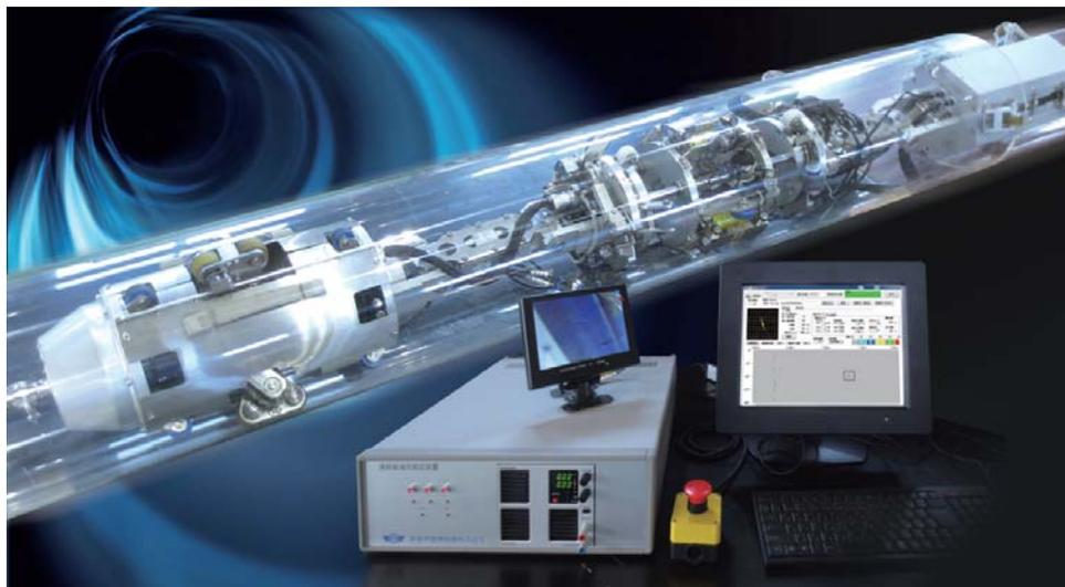
T-MAGMOLEは、3chの磁化器と渦電流センサーを搭載し、埋設管内を自走することで、配管の腐食を非接触で連続的に測定する装置です。測定結果はカラーマップで表示します。また、装置を3連結することにより、90°エルボ4カ所を自走で通過可能です。また、内面状況を確認する目視検査装置も準備しています。
