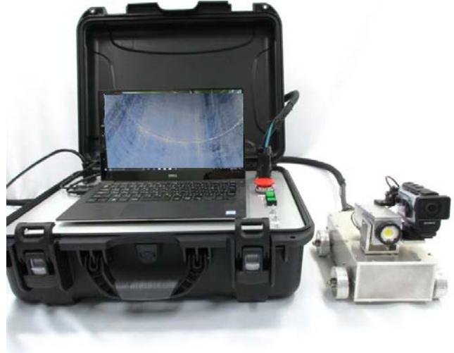
本装置は4つの車輪がマグネットになっており、これにより検査対象物(強磁性体)へ吸着して走行します。これまで高所や配管内等で接近が困難であった場所への適用が可能です。搭載しているカメラは首振り操作により左右90°、上下30°の範囲で旋回するので、見たいところをスムーズに観察することができます。
