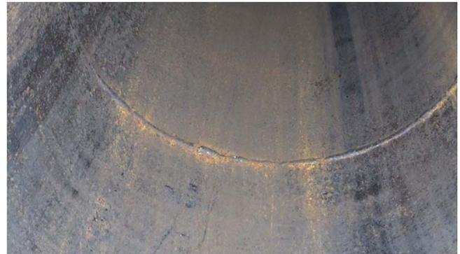
300 A配管内部溶接部撮影画像
