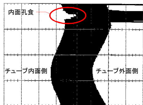
探傷画像(内面孔食の例)
