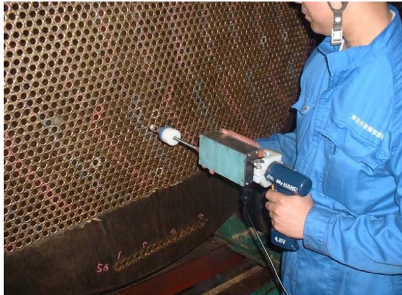
熱交換器管板部近傍については、拡管残留応力または振動の支点になることから、振動割れや応力腐食割れが発生しやすい箇所です。管板部近傍については拡管や管板の影響により、きず信号を検出することが困難でしたが、今回、管板部近傍に発生した割れに対し、高い検出力を持つ回転プローブを開発しました。また、回転治具により一定速度でムラが無く、高速度の探傷が可能となっています。
