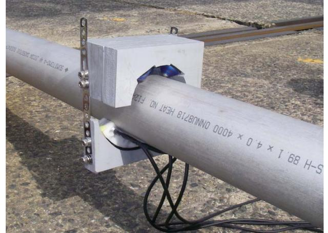
本装置は、超音波厚さ測定では検出困難な微細な内面孔食を効率的に検出できる手法です。本手法では、熱交換器チューブ検査において一般的に適用されている位相解析法の適用が可能であり、±10%程度の精度で孔食深さの評価が行えます。また、多チャンネルセンサーを取り付けた専用治具により、長尺の配管を効率良く検査できます。
