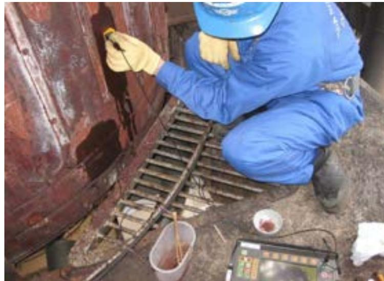
常温の溶接部では広く行われている斜角探傷試験ですが、高温下では一変して超音波機材等の耐久性の問題、あるいは超音波特性的変化により施行が困難になります。一般には、通常探触子ではくさび音速等の差により、きずエコー位置が正確に把握出来ないとされています。
