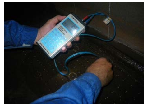
厚さ測定状況
