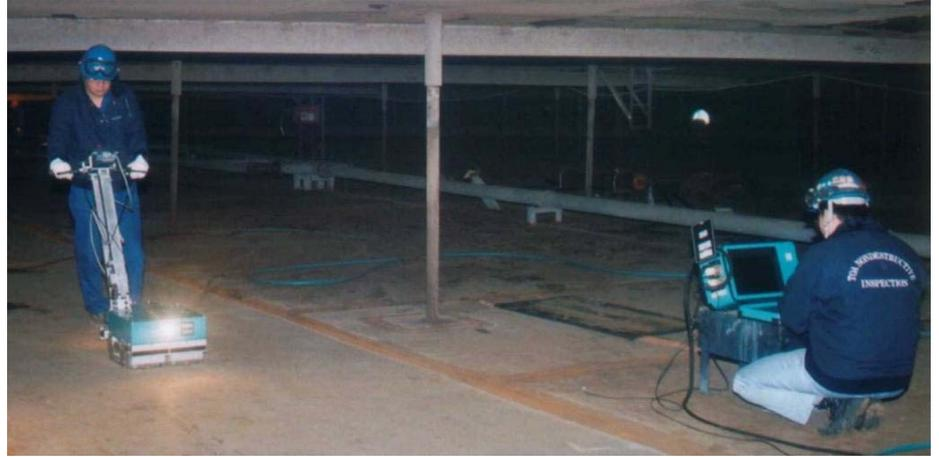
石油タンク底板の検査は、タンク開放時に定点の板厚測定が一般に行われています。しかしながら、定点測定では、タンク底板の最大腐食箇所を特定することは極めて困難であり、また、特定するためにはタンク底板全面探傷が必要となりコスト、工数の面で制約を受けます。
