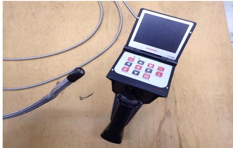
従来、熱交換器チューブや装置、部品の狭隘部の目視検査にファイバースコープを使用していましたが、CCDカメラを搭載した超小型工業用内視鏡(ビデオスコープ)の使用により、像質が飛躍的に向上し、小さなきずや腐食などの欠陥を鮮明に観察できるようになりました。また、観察結果はビデオによる保存が可能で、何度でも繰り返し観察でき、高度な診断が行えます。
