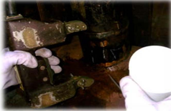
極間法による探傷方法
