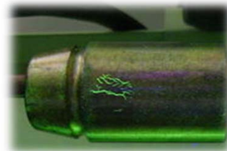
割れによる磁粉模様 (蛍光磁粉)
