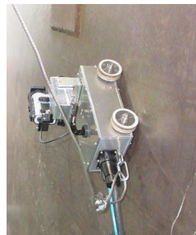
垂直鋼板走行状況
