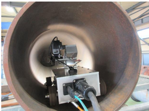
300 Aモックアップ配管内部走行状況
