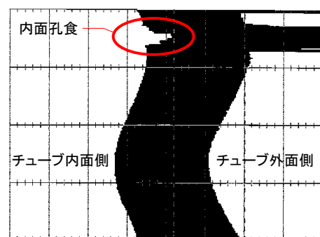
探傷画像(内面孔食の例)
