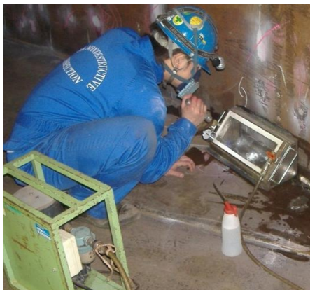
真空法の試験状況
